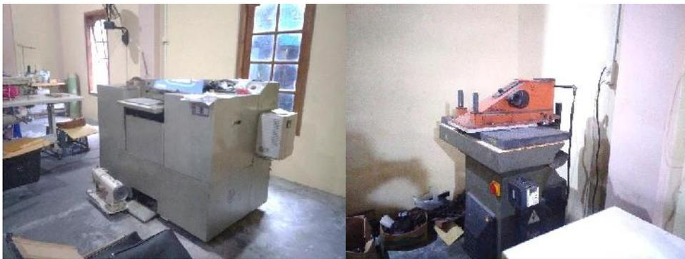
Gambar 4.6 Mesin Split Kulit dan Mesin Potong Hidrolis di Usaha Non Sentra
